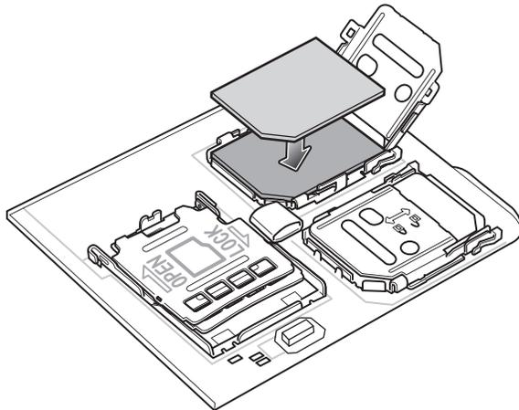
5. Schließen Sie die Abdeckung des SIM-Kartenhalters, bis sie einrastet.
