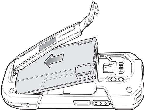
4. Drücken Sie den Akku nach unten in das Akkufach, bis die Akkuentriegelungen hörbar einrasten.
