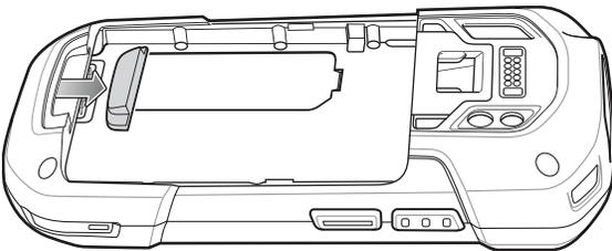
2. Legen Sie die Platte der Handschlaufe in den Schlitz für die Handschlaufe.
