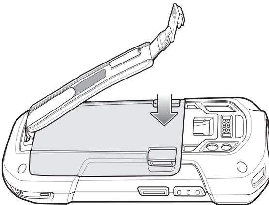
5. Schieben Sie die Halteschlaufen-Halteklemmer in den Halteschlaufen-Befestigungsschlitz, und ziehen Sie sie nach unten, bis sie einrastet.
