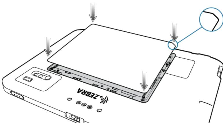
3. Drücken Sie die Abdeckung vorsichtig an den Kanten entlang nach unten. Vergewissern Sie sich, dass die Abdeckung ordnungsgemäß auf dem Gerät sitzt.
