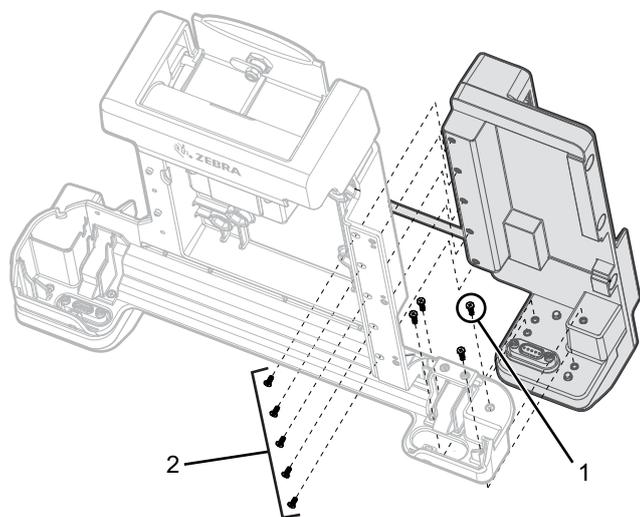
4. Branchez le câble d'alimentation du module d'extension de port sur le port de sortie d'alimentation (1) de la station d'accueil.
