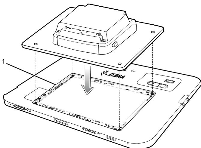
4. Совместите небольшие пластиковые фиксаторы на задней стороне расширенной задней панели с пазами на планшете.
