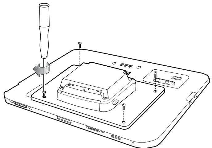
**NOTA:** La flecha grabada en la parte posterior de ampliación indica la ubicación de los contactos de la tarjeta.
