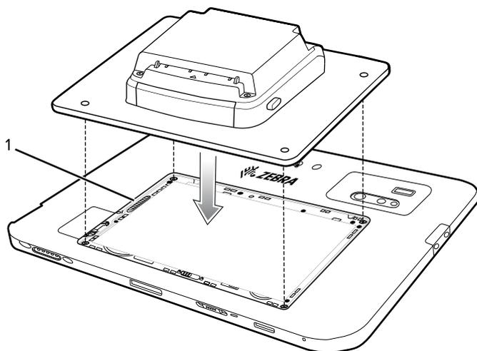
4. Alinee los pequeños clips de plástico en la parte trasera de la parte posterior de ampliación con las ranuras de la tableta.
