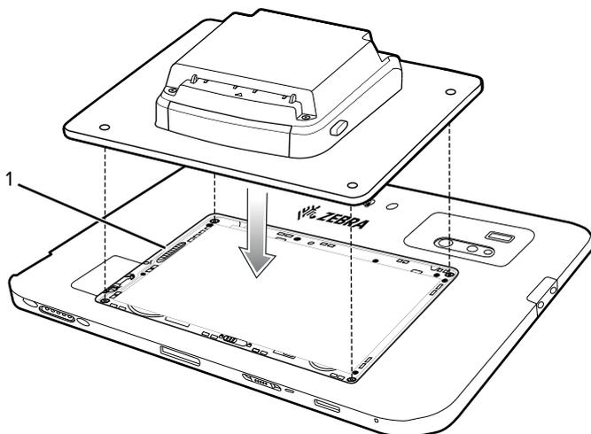
4. Richten Sie die kleinen Kunststoffclips auf der Rückseite der Erweiterungs-Rückabdeckung an den Schlitzen im Tablet aus.
