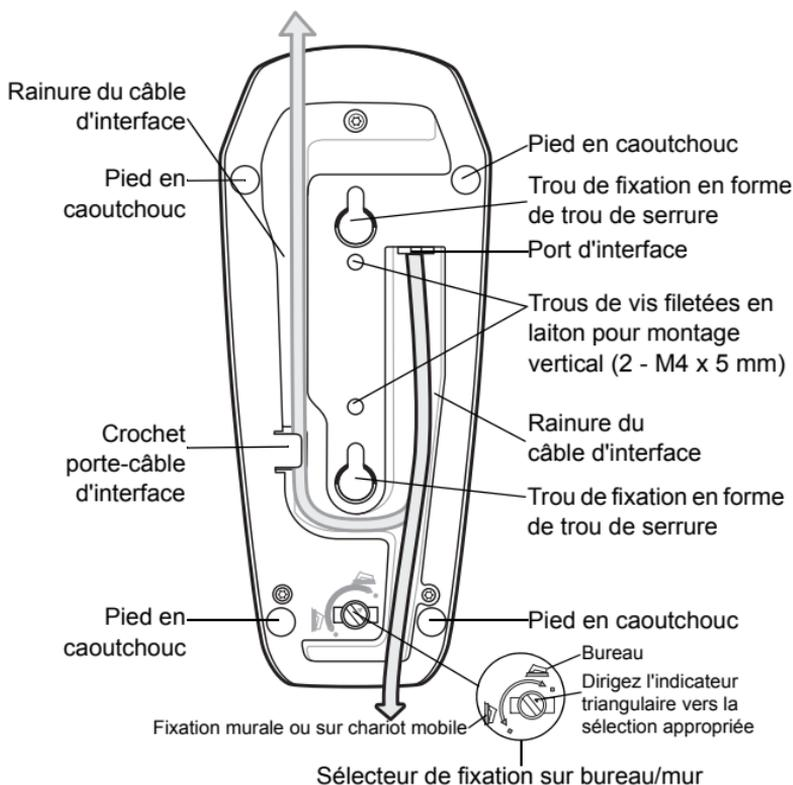
✓ **REMARQUE** En cas de montage sur un chariot mobile, le sélecteur de fixation sur bureau/mur doit être en position de montage mural (verrouillé).
