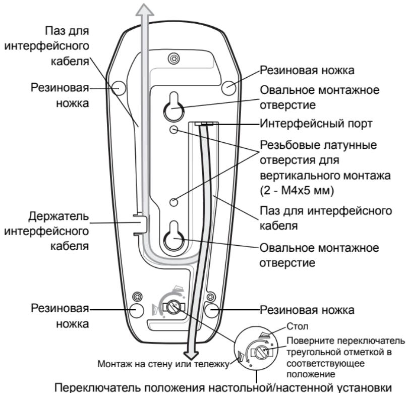
**ПРИМЕЧАНИЕ** При установке на подвижной тележке переключатель положения установки на столе/стене должен быть установлен в положение настенной установки (заблокировано).
