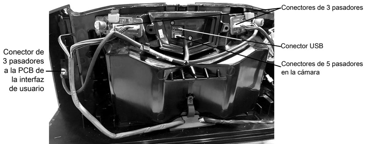
17. Conecte el cable USB y páselo por debajo de la lengüeta del retén para cable, a través de los rebordes de guía 1 y 2 hacia el lado del dispositivo.
