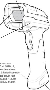
LUMIÈRE LASER - NE PAS REGARDER DANS LE FASCICULE APPAREIL À LASER DE CLASSE 2. DS3608-SR - Étiquette non applicable DS3608-DP - Étiquette située sur le côté du lecteur.
