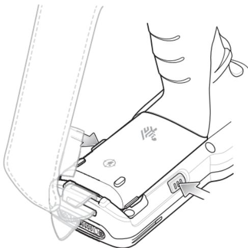
2. Retire la batería del compartimento de la batería.
