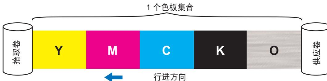
打印机将会识别已安装的打印色带类型，并将其显示在“类型”字段中。可用的色带组合显示在“组合”下拉菜单中。此外，“双面打印”设置和“在同一面上打印和编码”设置将会影响可用的色带组合。“剩余图像”状态栏将会显示已安装的色带还可以打印多少个图像。该功能适用于带有色板的色带和色板集合 (YMCK)；单色色带不适用。如果色带夹中剩余 10 个色板集合，则会显示警报消息“色带不足”。
