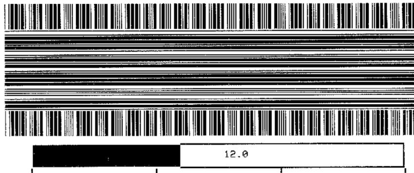
使用图像上的数字来确定最佳打印色深度。根据需要，更改打印色深度设置，直至能够在上述标签中获得最佳结果。（请参阅第 106 页的“打印色深度”。）
