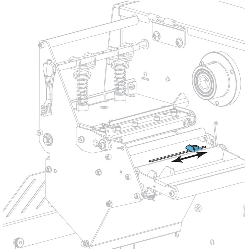
4. 在后方辊轮下，找到底部介质传感器组件。
