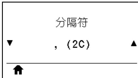
分隔符是一个两位十六进制值，在 ZPL/ZPL II 格式指令中用作参数位置标记符。设置分隔符，使其与标签格式中使用的值匹配。
