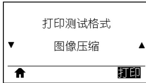
打印机打印一张带有对角线、圆圈和图像边缘均匀分布有刻度标记的图像，这有助于发现与图像压缩或拉伸相关的问题。您还可以测量刻度标记之间的距离，或对比圆圈或线条，以确定是否有变形的地方。
