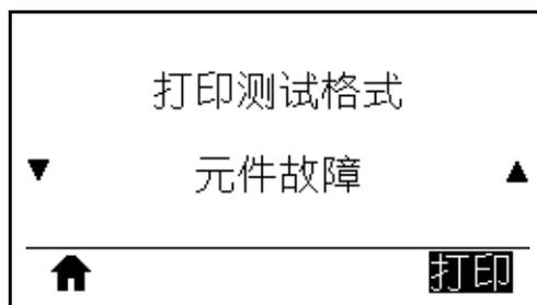
打印机打印一张横向图像，该图像专用于显示打印头元件能否正常工作。
