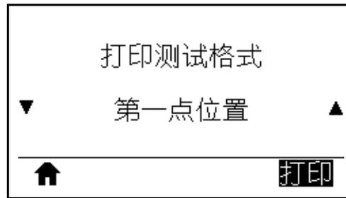
根据需要，打印机会打印一张图像来帮助您调节标签上的图像位置。图像上的线条从标签顶部打印到左边，以确定标签左上角应该是什么。
