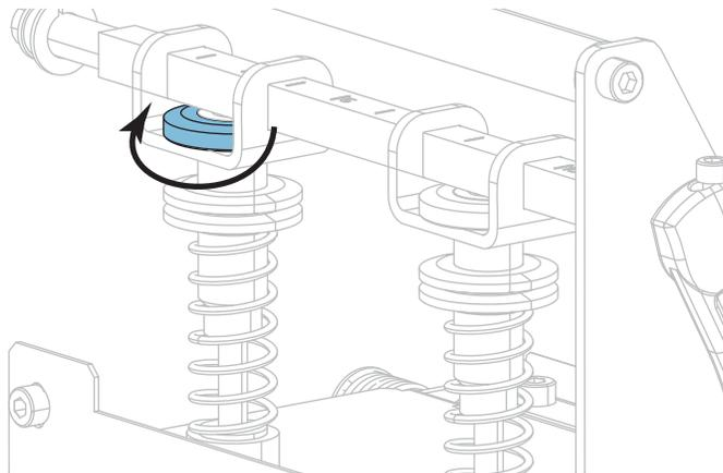
3. 根据需要，调节压紧件的位置，以便在介质上施加均匀的压力。对于非常窄的介质，应将内侧压紧件放置在介质的中央，并减小外侧压紧件上的压力。
