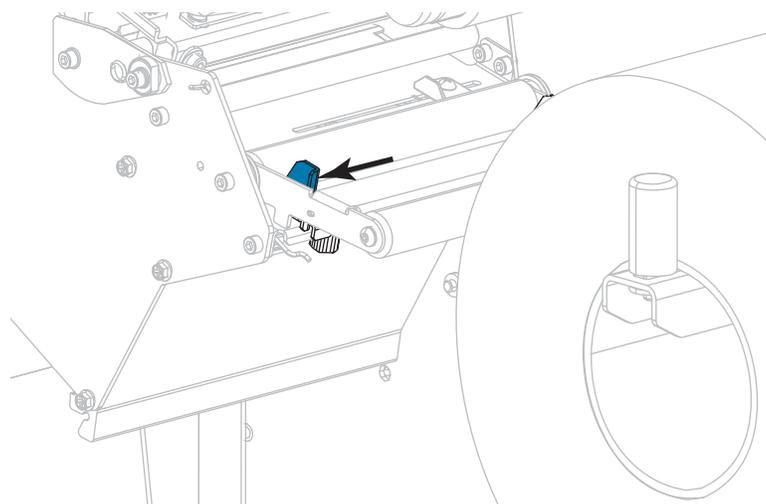
5. 将介质从介质张力调节器总成辊轮 (1)、介质导板辊 (2)，及上方介质传感器 (3) 的下方依次穿过。
