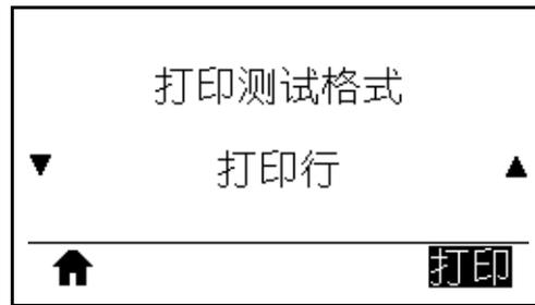
打印机多次以不同的速度启动一个测试序列，打印一张油墨/打印头测试图像。当对打印机的机械组件进行调节时，可以使用这些测试标签，也可用于确定打印头元件工作是否正常。
