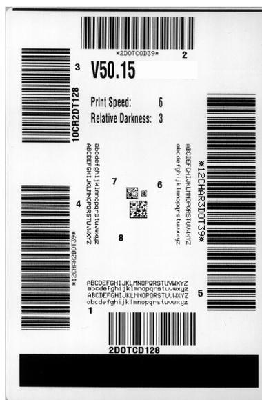
4. 请参阅第 217 页的“条形码质量判断”。检查测试标签并确定哪张标签具有适合您应用的最佳打印质量。如果有条形码检验器,可以使用它测量条形/空隙并计算打印对比度。如果没有条形码检验器,则可以使用目测方法或系统扫描仪根据在本自检中打印的标签选择最佳打印色深度设置。
