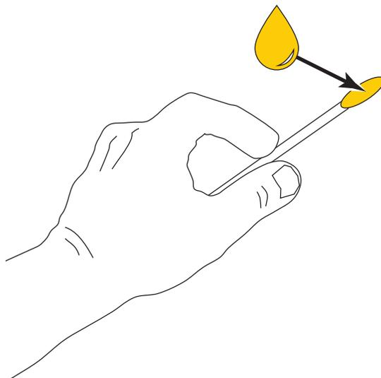
11. 在两个切纸器刀刃的所有可见表面上都均匀涂抹一层润滑油。清除多余的润滑油，这样它就不会接触到打印头或打印辊。
