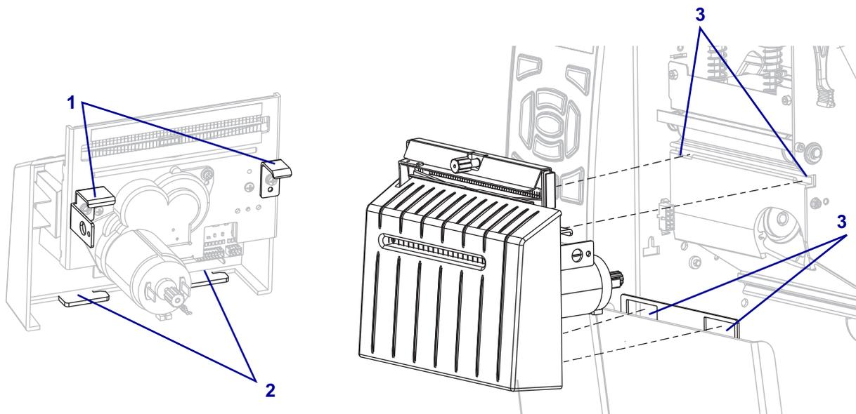
8-f. 向左滑动切纸器模块，然后重新安装好切纸器安装螺钉。
