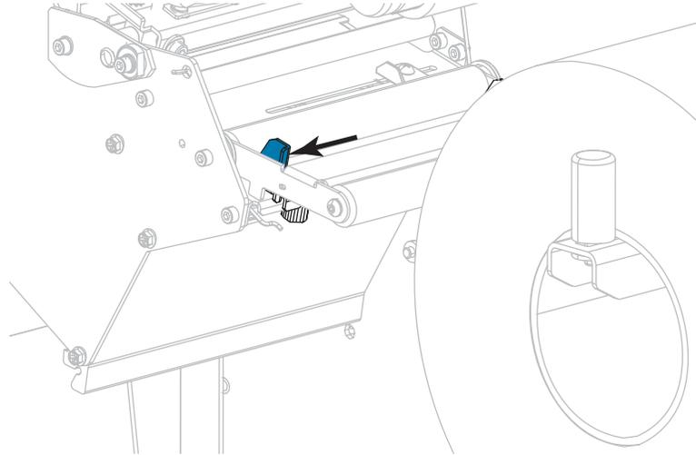
6. 将介质从介质张力调节器总成辊轮 (1)、介质导板辊 (2)，及上方介质传感器 (3) 的下方依次穿过。
