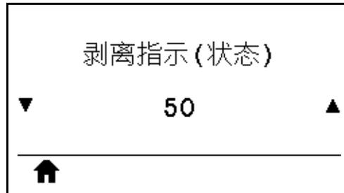
设置剥离指示 ( 状态 ) 指示灯的亮度。
