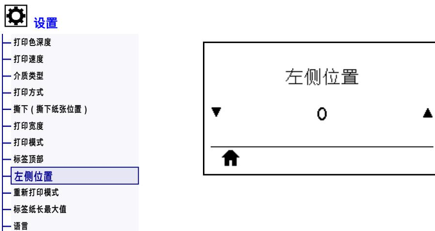
根据需要，调节图像在标签上的横向打印位置。
