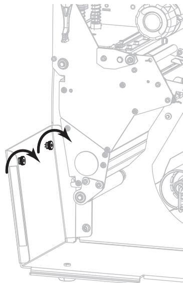
2. 使回卷/背衬拾取辊上的锁眼的大孔对准压花螺母，然后将回卷/背衬拾取辊滑下去，直到碰到螺栓。
