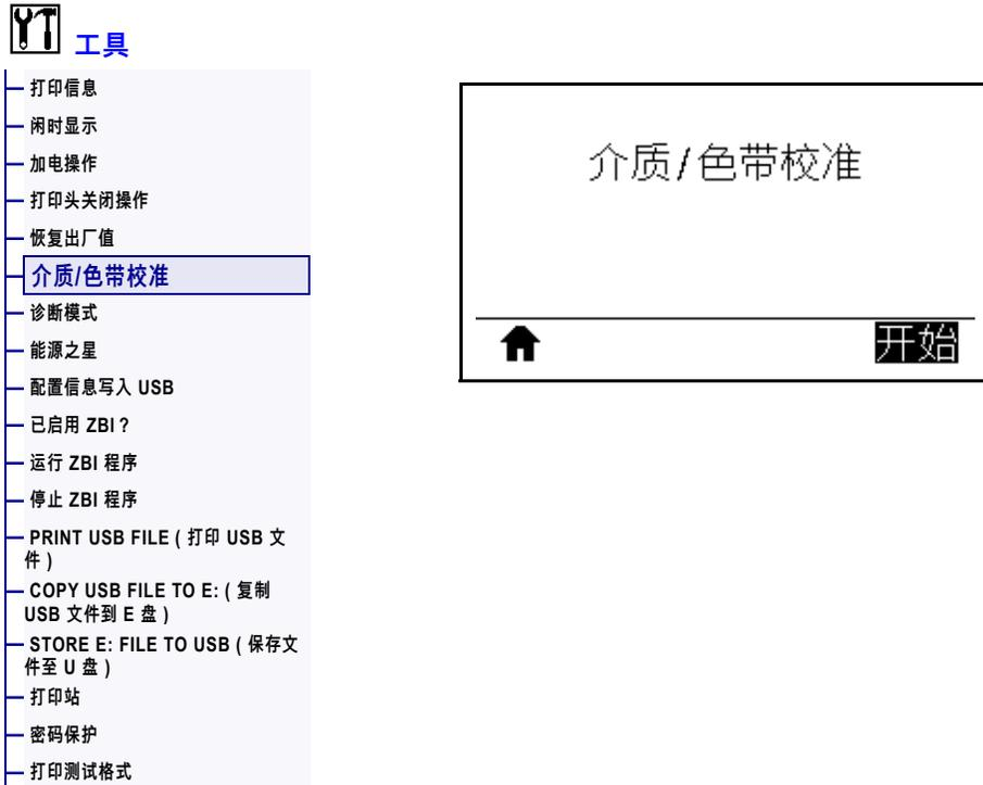
校准打印机，调节介质和色带传感器的灵敏度。
