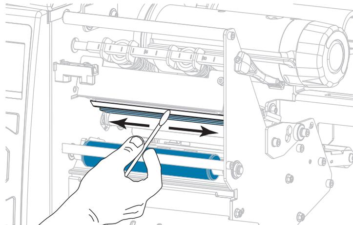
5. 在手动旋转打印辊时，应使用棉签对其进行充分清洁。让溶剂挥发干净。
