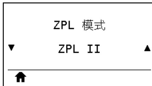
选择与标签格式中使用的值匹配的模式。本打印机可以接受使用 ZPL 或 ZPL II 语言编写的标签格式，不需要重新编写任何已经存在的 ZPL 格式。在使用下列一种方法更改模式之前，打印机一直在选定的模式下工作。
