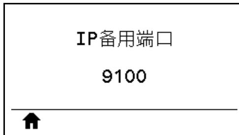
该命令用于设置 TCP 替代端口的端口号。
