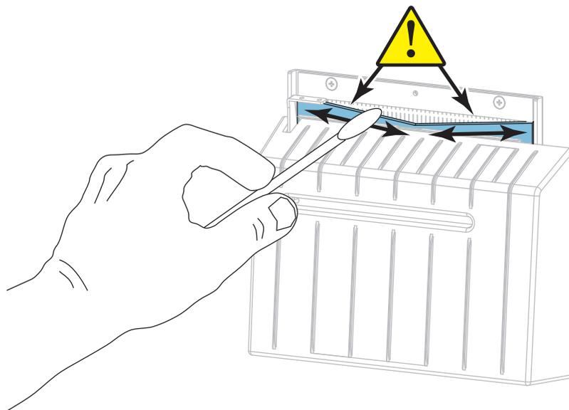
10. 溶剂蒸发后，将一根清洁的棉签浸入到多用途的高黏度硅酮或 PTFE 润滑油中。
