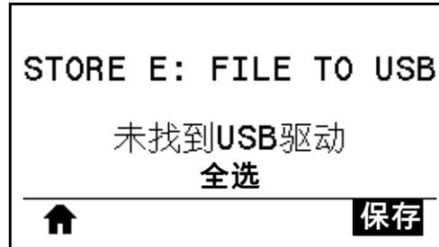
“全选”选项可将打印机上的所有可用文件存储到 USB 闪存盘中。所有已复制的 .ZPL 文件都会进行后处理，使其内容适合发送到打印机，以便能够正常执行。
