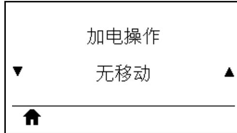
设置打印机在加电时执行的操作。
