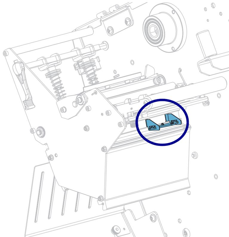
5. 滑动底部介质传感器，直到它位于顶部介质传感器的下方。可根据需要将电线轻轻拉出（电线应稍稍松弛）。
