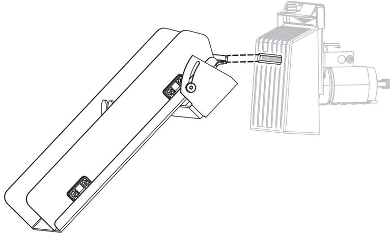
5. 松开并卸下切纸器外壳上的指拧螺钉和锁紧垫片。
