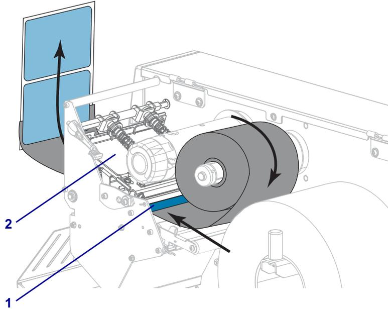
7. 将色带引头穿过顶部色带滚轮 (1) 上方和色带拾取轴 (2) 下方。将引头和色带卷绕在色带拾取轴上 ( 如图所示 )。将拾取轴旋转几圈，卷绕色带，以收紧松弛部分。
