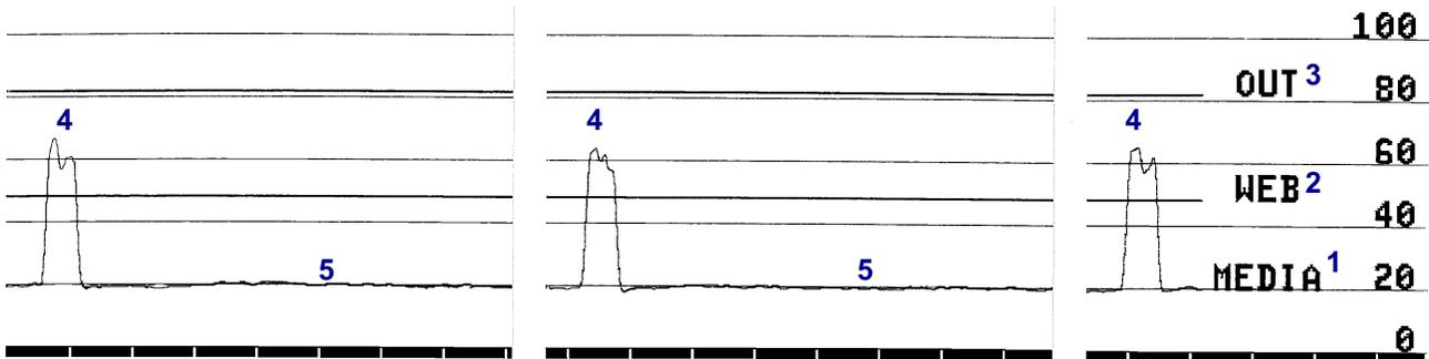
图 22 • 介质传感器校正图 ( 黑色标记介质 )
