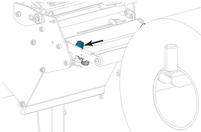
7. 将介质从介质张力调节器总成轱轮 (1)、介质导板轱 (2)，及上方介质传感器 (3) 的下方依次穿过。
