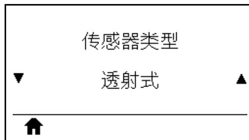
选择适用于用户所用介质的介质传感器。反射式传感器通常只用于黑色标记介质。透射式传感器通常用于其他介质类型。
