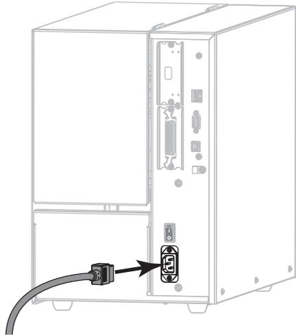
5. 将交流电源线的插头一端插入适合的电源插座。
