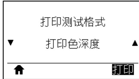
打印机以不断增加的打印色深度等级重复打印同一张图像。当图案清晰可辨时，随时按“取消”按钮停止打印过程。
