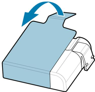
3. 向上拉电池组底部的绝缘片。
