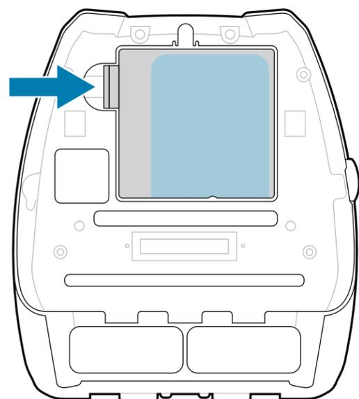
1. Appuyez sur la languette de déverrouillage de la batterie.
