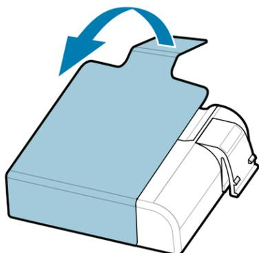
3. Tirez sur la languette de l'isolant adhésif situé au bas du bloc-piles.
