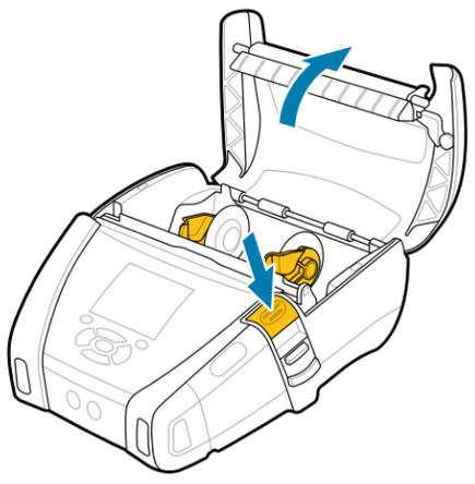
2. Insérez le rouleau de support dans le compartiment dans l'orientation illustrée.
