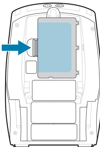
1. Premere la linguetta di rilascio sul pacco batteria.
