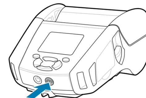
Nhấn nút **FEED (NẠP)** để đưa giấy in vào qua đường dẫn giấy.
