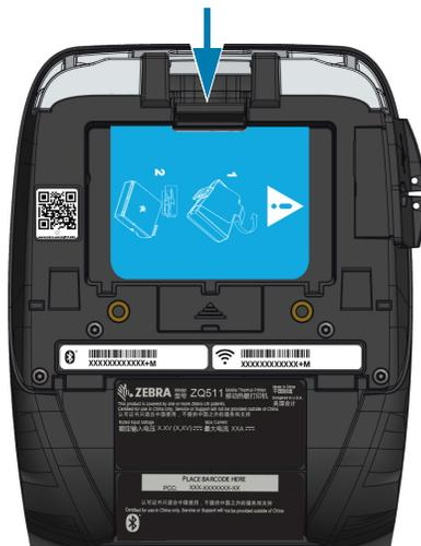
3. Gire o pacote de bateria para a frente e levante-o para fora do compartimento da bateria (Figura 6).
