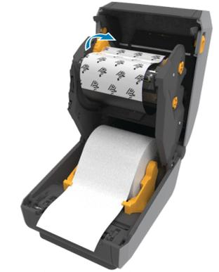
旋转色带拾取转轮，以取出纸卷并向前推送色带。
