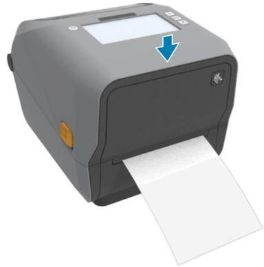
向下按压打印机的前端，直至锁定。
