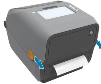
将松开锁片滑动至前端，松开打印机盖。
