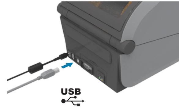
将 USB 线缆的一端连接至打印机，另一算连接至您的计算机。
