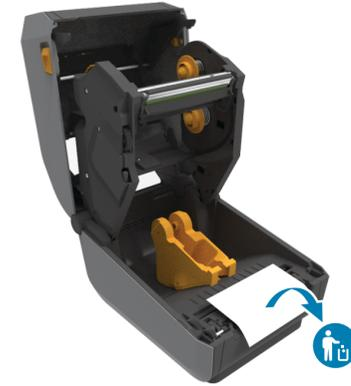
打开打印机盖，并拆下包装物。
