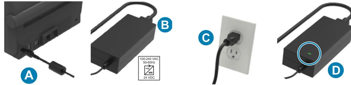
A. 将电源部件一端插入打印机。
