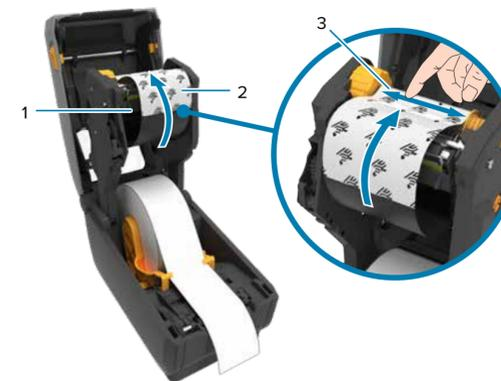
向上拉动色带供给导线 (2)，使其位于打印头 (1) 上方，然后将其连接到张紧轴 (3)。
