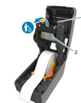
Abra a impressora e descarte a fita usada. Mantenha a bobina de suprimento vazia (2) para ser utilizada no próximo recolhimento de fita (1).
