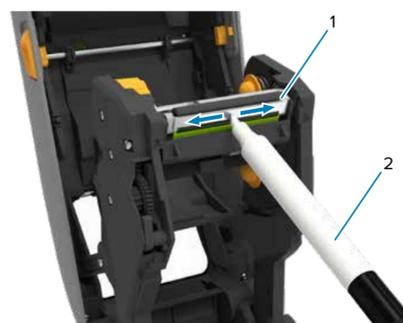
Limpe o cabeçote de impressão (1) com uma caneta de limpeza (2). O movimento deve ser feito do meio para fora. A caneta de limpeza serve apenas para cabeçotes de impressão.
