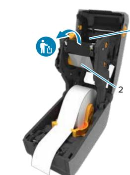
Abra a impressora e descarte a fita usada. Mantenha a bobina de suprimento vazia (2) para ser utilizada no próximo recolhimento de fita (1).
