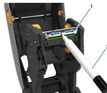
Limpe o cabeçote de impressão (1) com uma caneta de limpeza (2). O movimento deve ser feito do meio para fora. A caneta de limpeza serve apenas para cabeçotes de impressão.
