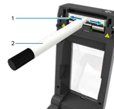
Limpe o cabeçote de impressão (1) com uma caneta de limpeza (2). O movimento deve ser feito do meio para fora. A caneta de limpeza serve apenas para cabeçotes de impressão.
