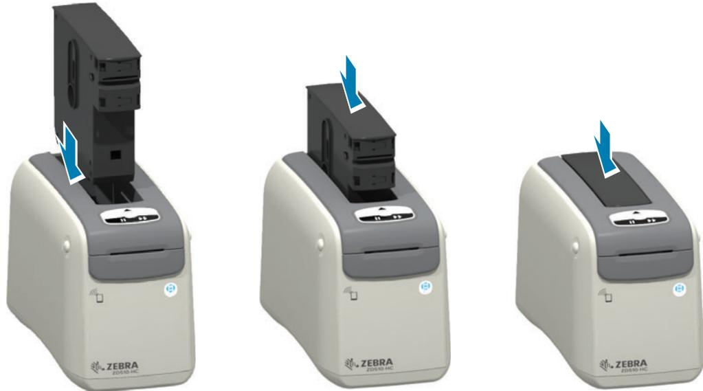
4. **Nota** - La stampante prepara un braccialetto per la stampa, sposta il supporto (braccialetto) nello slot di uscita dei supporti (posizione pronta per la stampa) e legge i parametri operativi della cartuccia supporti e i dati.
