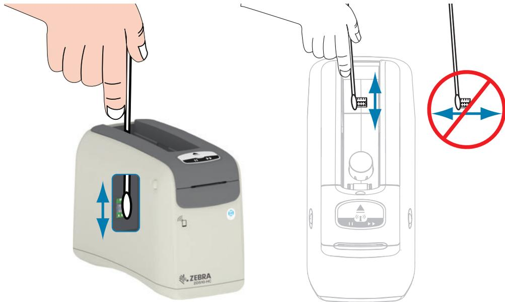
1. Utilizzando un bastoncino privo di fibre imbevuto in una soluzione di alcool isopropilico (minimo 99%) ed effettuando solo movimenti verticali, pulire i pin del sensore visibili sul retro dello slot della cartuccia dei supporti. Gettare i bastoncini usati.
