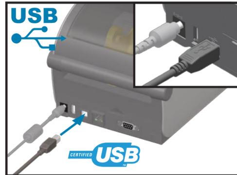
Conecte um cabo USB na impressora
